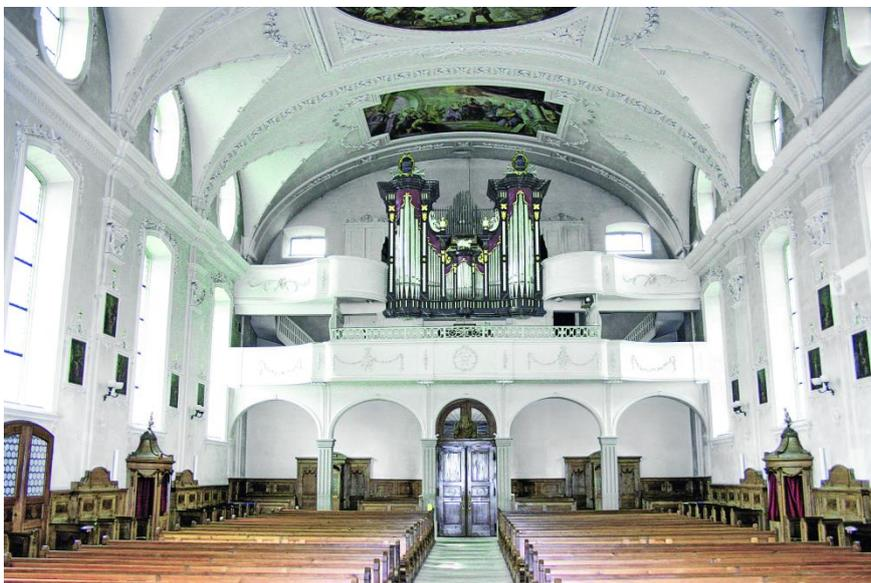
Für die Aufstellung eines freistehenden Spieltisches mit mechanischer Spiel- und elektro-pneumatischer Registertraktur, zahlreichen Koppeln und einer Crescendowalze sowie eines Barkerhebels für das I. Manual wurden der gesamte Orgelunterbau neu angelegt und eine moderne Windanlage installiert. Im klanglichen Bereich blieben der Grossteil der bestehenden Pfeifen Brauns sowie dessen Windladen (mit meist neuen Stöcken) erhalten.
